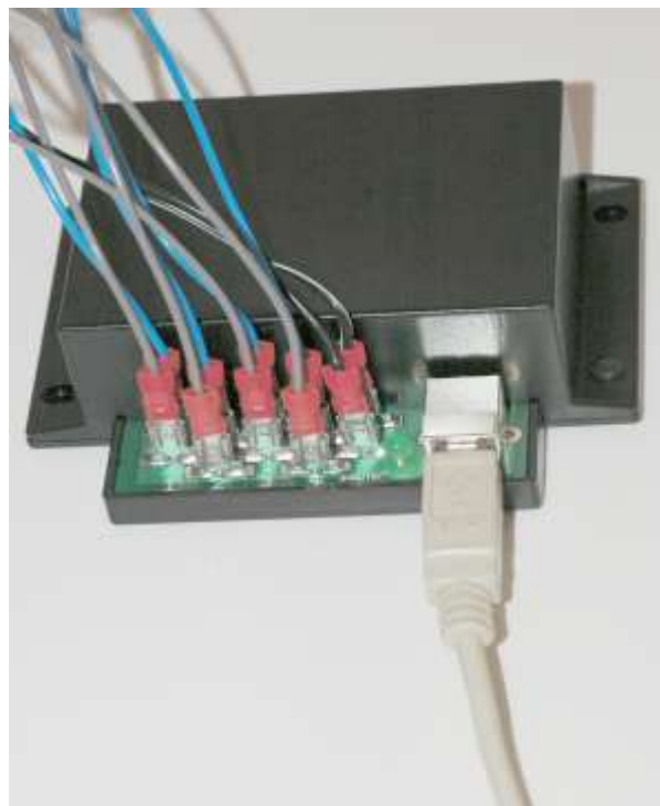
Figuur 1 De eerste flora-mate dimmer, gemaakt voor het aansturen van dimbare voorschakelapparaten
